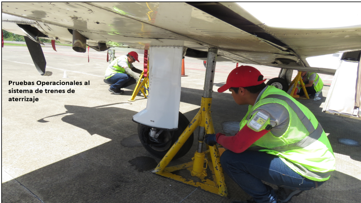
Imagen No. 3: pruebas operacionales efectuadas al sistema de trenes de aterrizaje aeronave HK-5126
